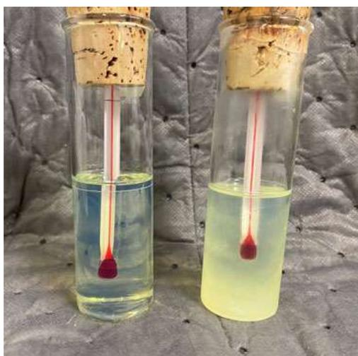
Το εργαστήριο της Power Service δοκιμάζει δεκάδες χιλιάδες δείγματα καυσίμων κάθε χρόνο χρησιμοποιώντας μεθόδους δοκιμών ASTM που είναι συμβατές με τον κλάδο, για να διασφαλίσει ότι η τεχνολογία anti-gel ή ψυχρής ροής που διαθέτουμε είναι κορυφαία στον κλάδο και αρκετά ισχυρή ώστε να επεξεργάζεται μια ευρεία διατομή καυσίμων, ακόμη και σε ακραίες χαμηλές θερμοκρασίες. Αυτές οι δοκιμές είναι: (1) Σημείο Θολώματος, (2) Σημείο Απόφραξης Ψυχρού Φίλτρου (CFPP) και (3) Σημείο Ροής.
